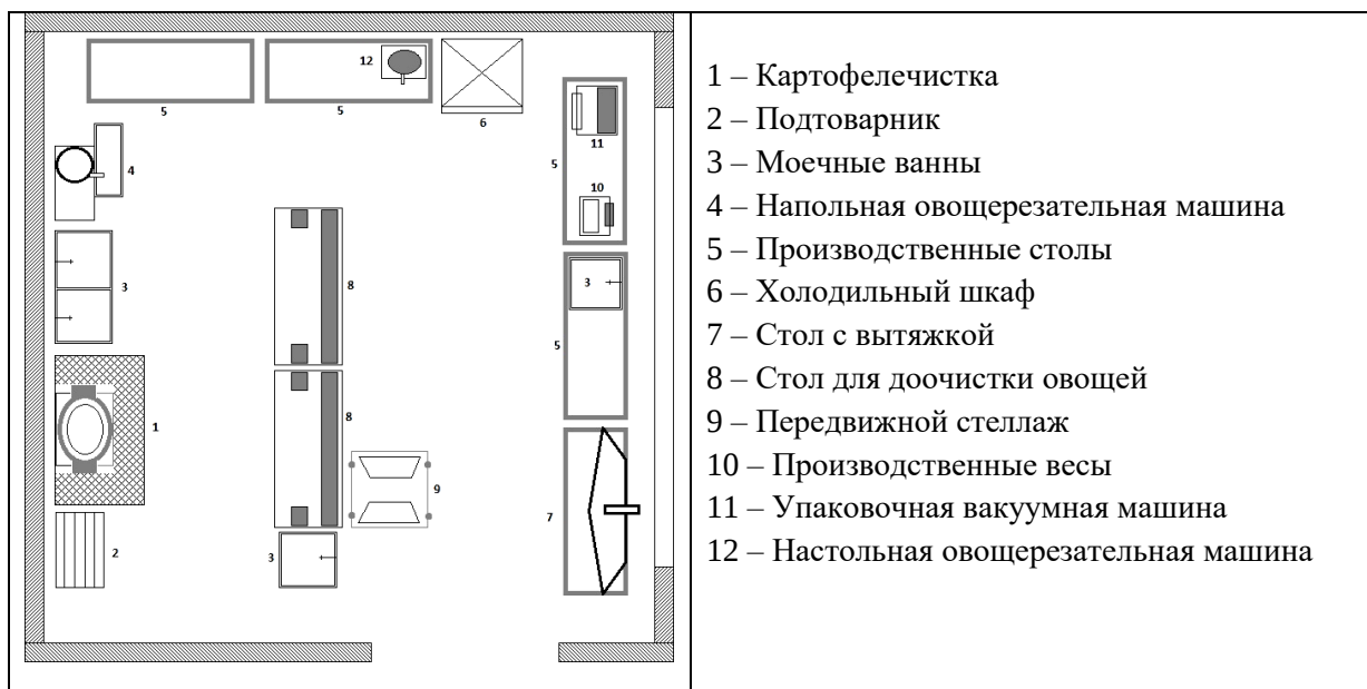
Рисунок 1 – Схема размещения оборудования в овощном цехе
