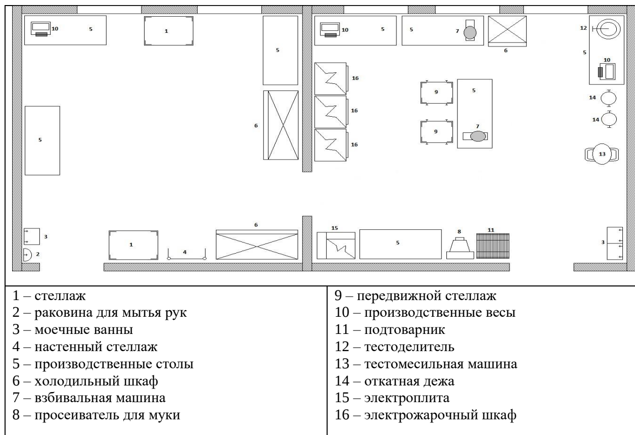
Рисунок 8 - Планировка помещений кондитерского цеха производительностью до 3 т изделий в смену
