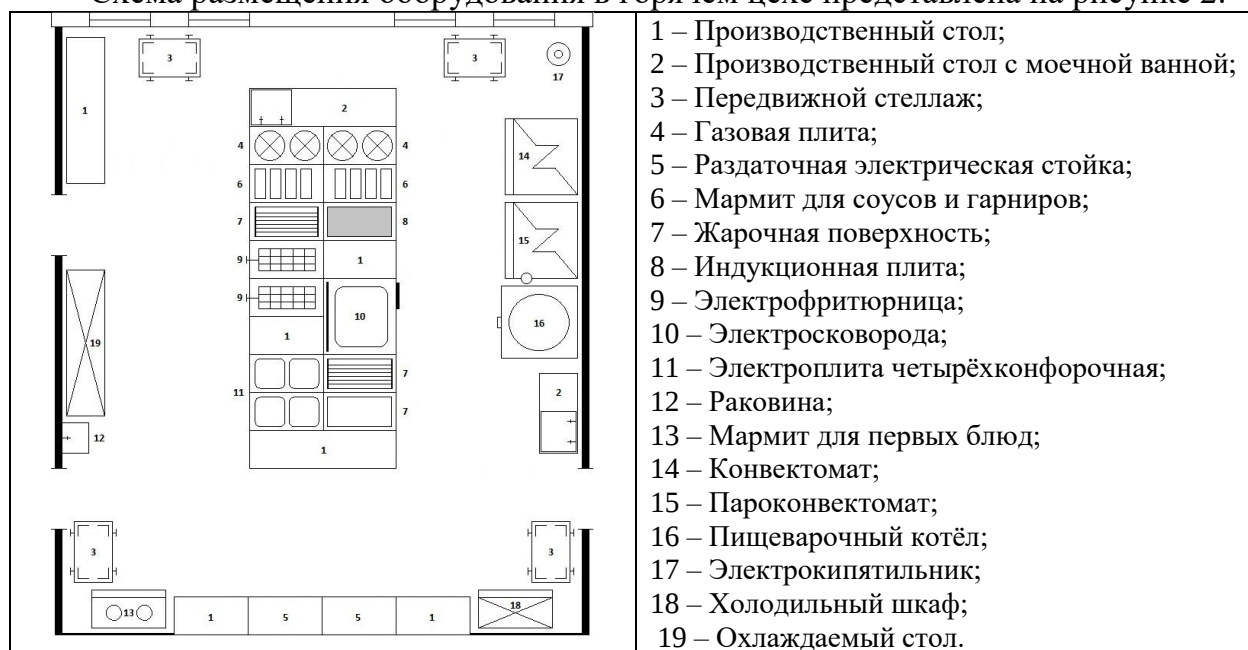
Рисунок 2 - Схема размещения оборудования в горячем цехе
