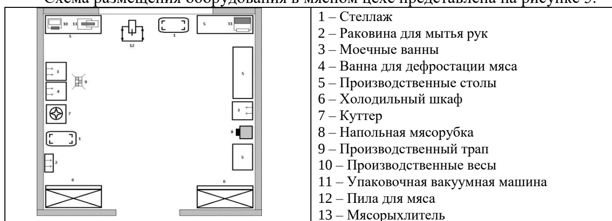
Рисунок 5 - Схема размещения оборудования в мясном цехе
