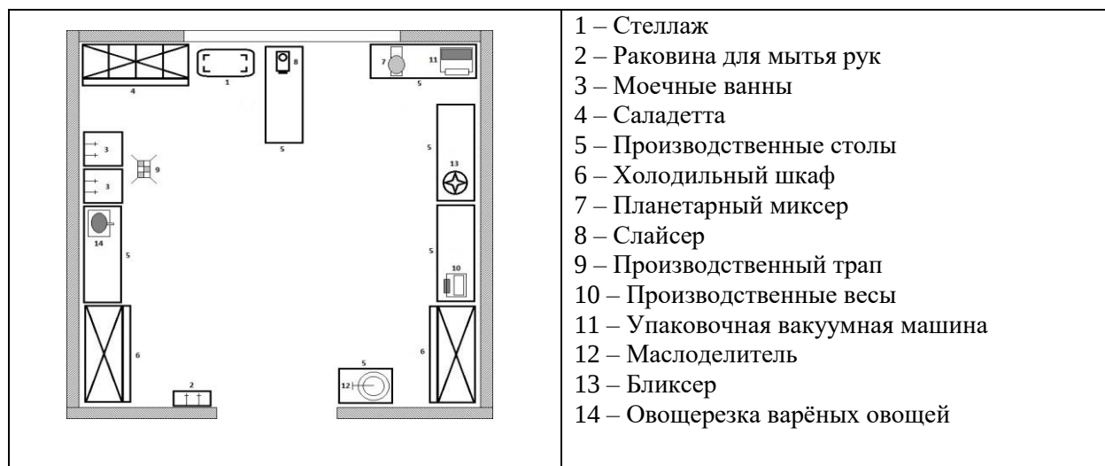
Рисунок 4 - Схема размещения оборудования в холодном цехе
