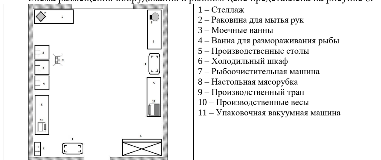
Рисунок 7- Схема размещения оборудования в рыбном цехе
